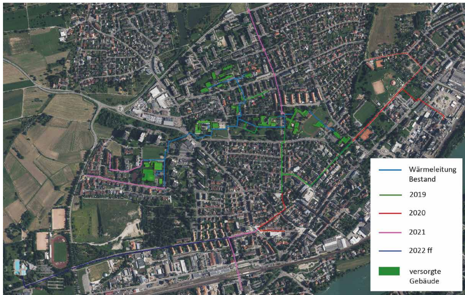
Struktur der Wärmeversorgung in Rheinfelden (Baden) 2022+
