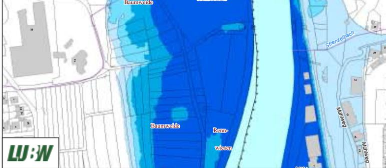
Ausschnitte aus einer Hochwassergefahrenkarte mit der Darstellung der Überflutungsflächen. Die unterschiedlichen Blaufärbungen zeigen die jeweils überflutete Fläche für Hochwasser, die statistisch alle 10, 50, 100 oder seltener als alle 100 Jahre auftreten. Auch in dieser Darstellung sind die bestehenden Hochwasserschutz-einrichtungen berücksichtigt. Das Szenario HQ<sub>extrem</sub> berücksichtigt auch das Versagen von Schutzeinrichtungen und die Verklauung von Brücken durch Treibgut.
